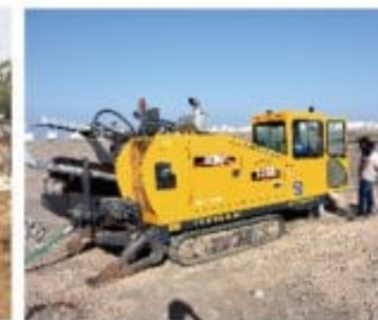
XZ200水平定向钻机在阿曼施工 XZ200 HDD working in Oman
